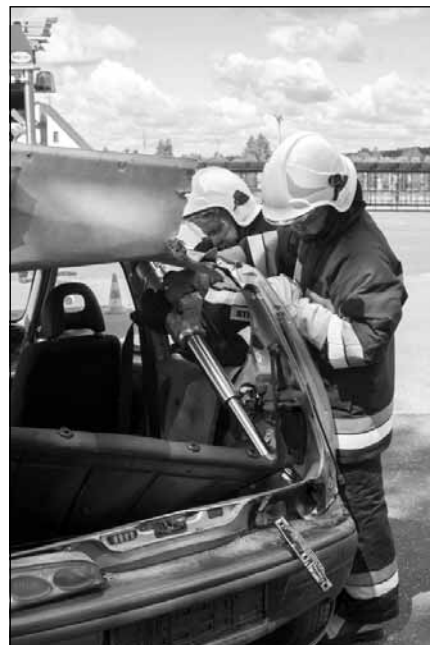
Powiększenie przestrzeni działania poprzez odgięcie tylnej kanapy cylindrem rozpierającym.
